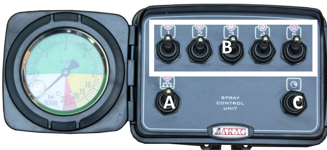
Rysunek 19. Panel sterowania układem cieczowym opryskiwacza GOLIAT 5200/6000 PHR.
