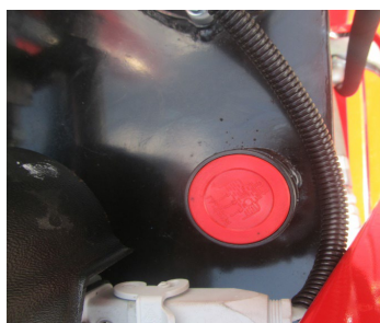
Rysunek 34. Korek wlewu oleju.
