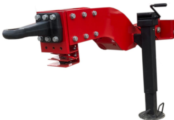
Rysunek 26. Pozycja postojowa wspornika mechanicznego dyszla
