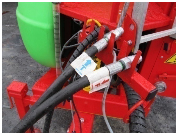
Rysunek 2. Przewody hydrauliczne umocowane prawidłowo.
